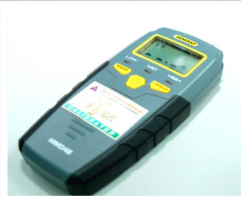
MOISTURE METER Checking moisture of cartons
